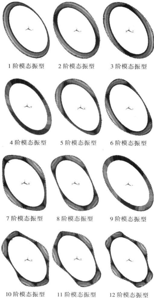
图 5 组合结构圆锯片前 12 阶固有频率的主振型图
